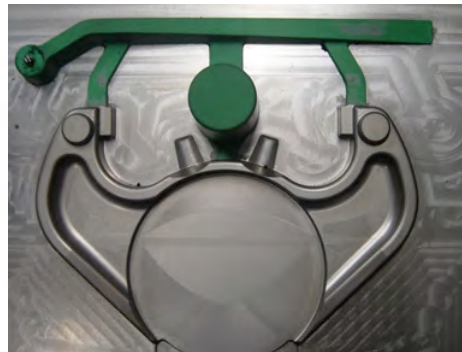
Figura 7. Foto del diseño revisado con alimentación única.
