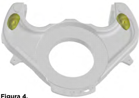
Figura 4. Áreas de alto valor de módulo en la pieza.
