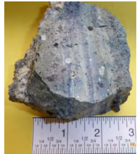
Figura 4: Escoria Insoluble quitada del horno de inducción coreless de Fundición G después de 48 horas de operación
