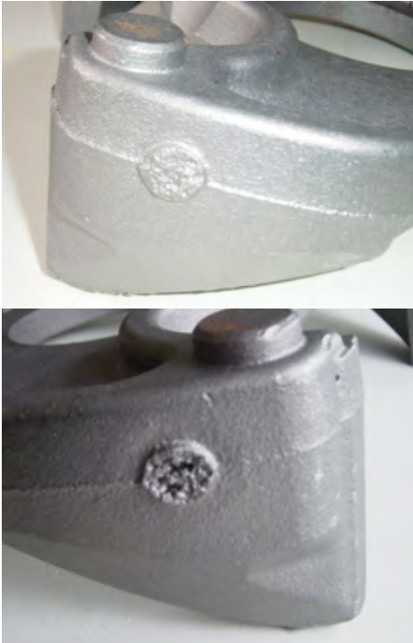
Figura 3. Contactos de alimentación con el diseño original (2 montantes).
