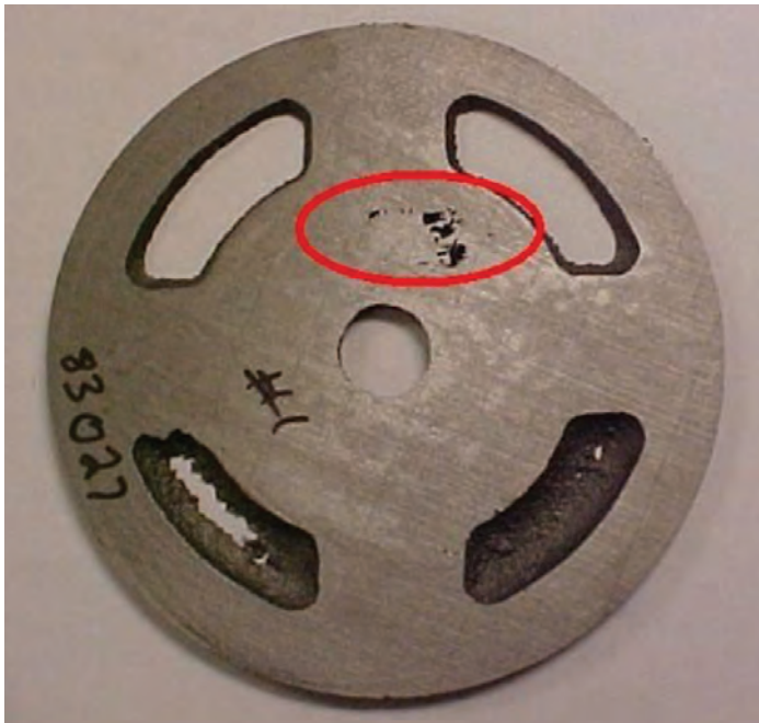
Imagen 1. Corte de la pieza izquierda, mostrando rechupe.
